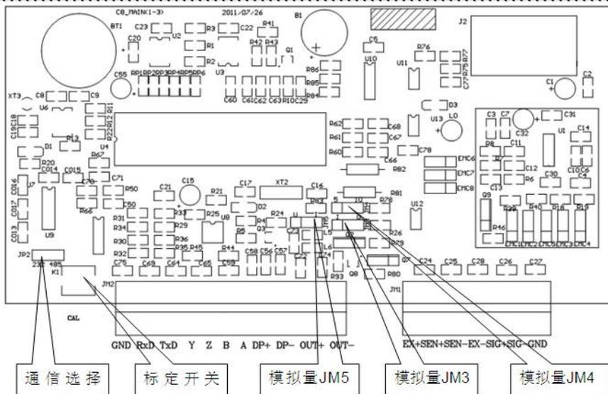
图3-3 主板跳线和标定开关示意图
